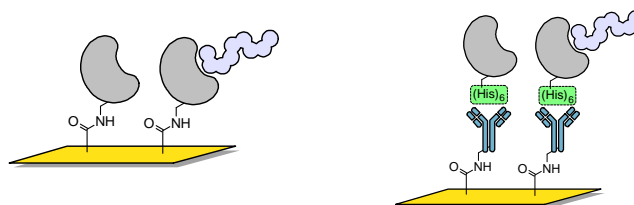
Rys. 1. Schematy immobilizacji receptorów na powierzchni przetwornika SPR.
